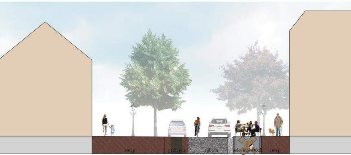
Profiel A-A' Pastoor Vonckenstraat (1:200 bij A4) stoep 6,2m parkeren 2m rijbaan 3,85m belevingsstrook 2,4m stoep 2,4m Maten huidige situatie stoep 3,4m parkeren 1,9m rijbaan 6,5m parkeren 1,9m stoep 3m
